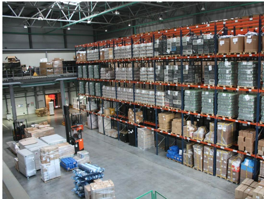
*Современные склады класса А со стеллажным многоярусным хранением и выделенной зоной комплектации. Вместимость стеллажной системы склада общего пользования составляет 3213 тонн, СВХ — 2 550 тонн.*
